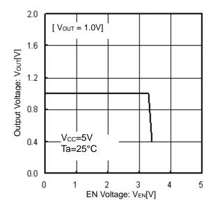
Figure 6. Output Voltage vs EN Volatge
