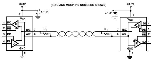
FIGURE 1. TYPICAL OPERATING CIRCUIT - ISL3179E
