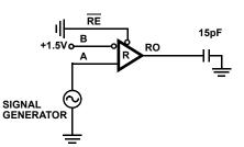
FIGURE 8A. TEST CIRCUIT
