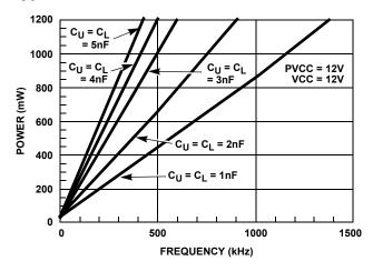
FIGURE 2. POWER DISSIPATION vs FREQUENCY
